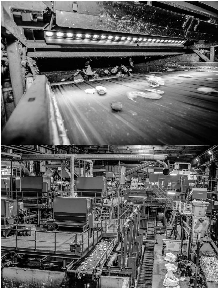
In der Niederlassung Beckum (Münster) werden vorsortierte oder gemischte Kunststoffe aus Verpackungen oder stoffgleichen Nichtverpackungen in homogene Kunststoffarten sortiert. Dabei werden moderne und hoch entwickelte Sortier- und Aufbereitungstechniken wie z.B. leistungsfähige optische Erkennungssysteme eingesetzt, die verlässliche und stabile Qualitäten diverser Sekundärrohstoffe (u.a. PET klar, PET bunt, PET opak, HDPE, PP, PO-Mischungen) erzeugen.
