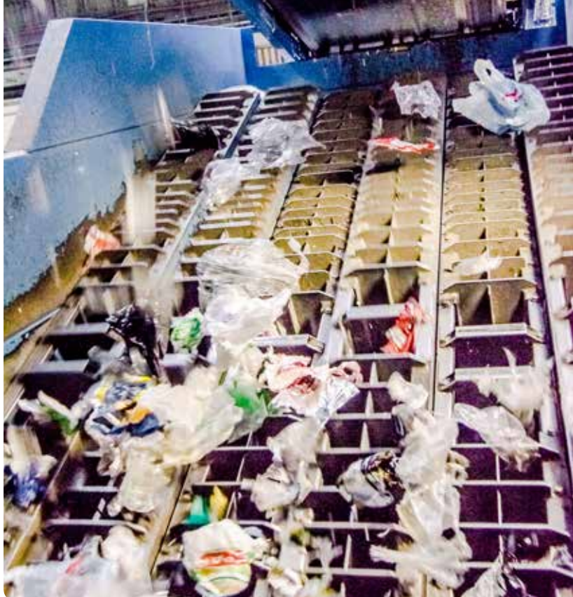
Ballistischer Separator zur Trennung von flächigen und körperförmigen Kunststoffen
