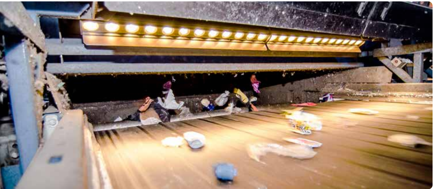
Multifunktions-Scanner mit integrierter RGB-Kamera zur Farbidentifizierung (Nahinfrarot)
